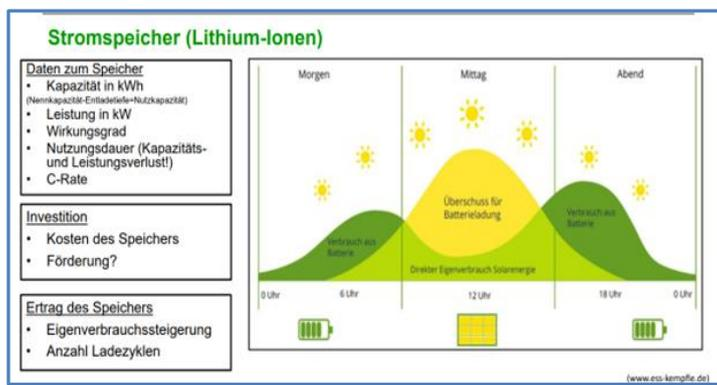
Der Speicher muss am Vormittag leer sein, um den überschüssigen Strom aus der PV-Anlage aufnehmen zu können und ihn dann am Spätnachmittag wieder abzugeben. Das erfordert einen kostspieligen Batteriespeicher
